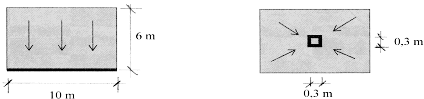
Obrázok 4: Odtoková šírka v prípade odkvapového žlabu (vľavo) a vtoku (vpravo).
