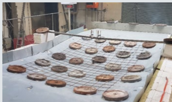
Požiarne odolnosť plochej strechy sa preveruje v certifikovanom skúšobnom laboratóriu na reálnej skladbe strechy
